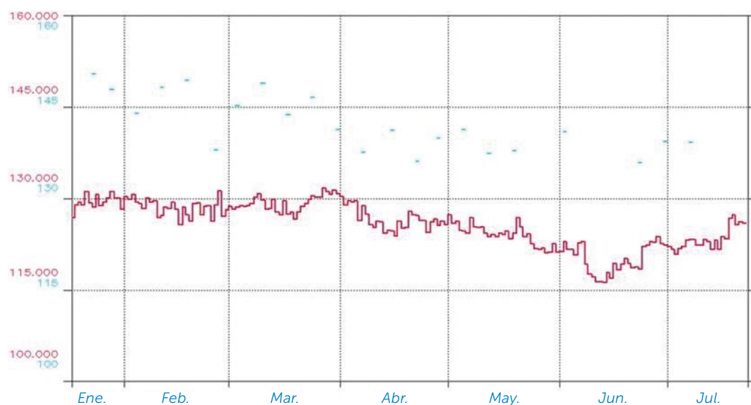
Tendencia de los datos del analizador en continuo (rojo) y de las mediciones puntuales de laboratorio (se dividirán entre 1,22)
